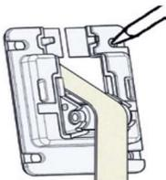
**4.** Schraubposition anzeichnen und ggf. Löcher bohren
