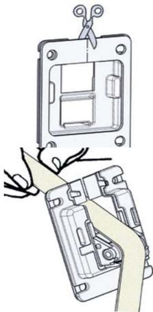
**2.** Dichtrahmen einschneiden, um den Gurt einzufädeln
