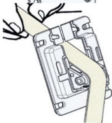
**3.** Gurt einfädeln und Gurtführung über dem Gurtauslass ausrichten
